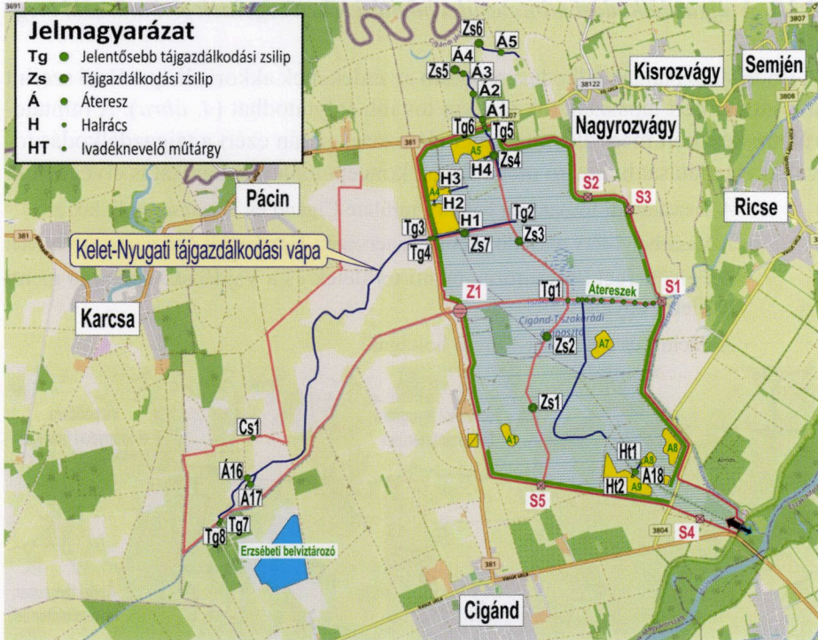
3. ábra. A cigándi árapasztó tározóhoz kapcsolódó tájgazdálkodási műtárgyak
