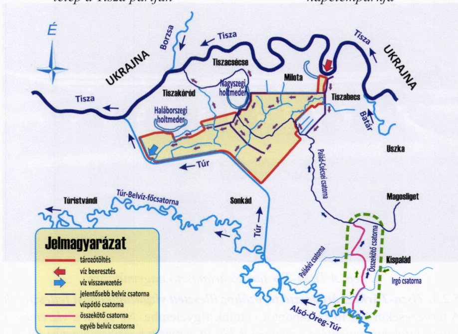
18. ábra. A Tisza-Túr árapasztó tározó tájgazdálkodási- természetvédelmi célú vízpótló rendszere
