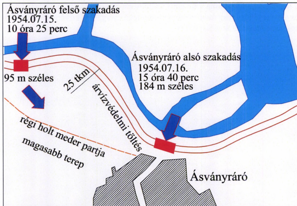
8. ábra. Az ásványrárói gátszakadások (Stelczer [2004] nyomán)
